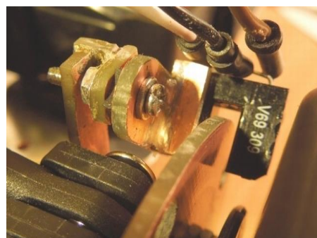
Obrázek 3: Mechanická kotoučová brzda. Optická závora na brzdovém kotouči. [3]
