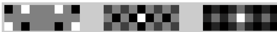
Obrázek 3: Příklady 3D konvolučních masek. Řezy 3D maskou jsou umístěny vedle sebe. Na prvním obrázku je příklad 3D konvoluční masky E3E3E3, na druhém obrázku je maska S3S3S3 a na posledním obrázku je zobrazena maska L3L3L3. Kde E3 je 1D filtr [-1 \ 0 \ 1] sloužící k zvýraznění hran, S3 je 1D filtr [-1 \ 2 \ -1] k detekci bodů, L3 představuje 1D filtr [1 \ 2 \ 1] pro určení lokálního průměru.
