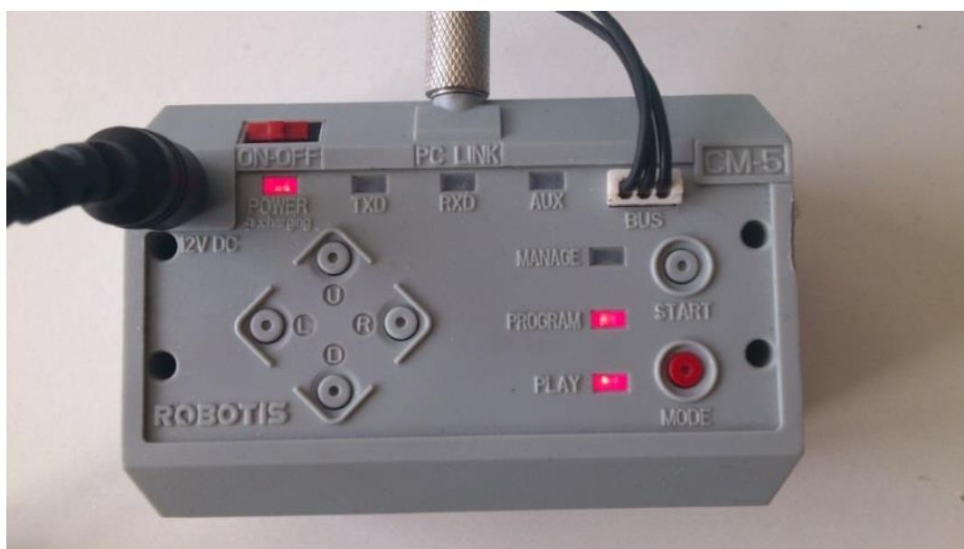
Obrázek č. 3: Řídicí stanice CM-5
