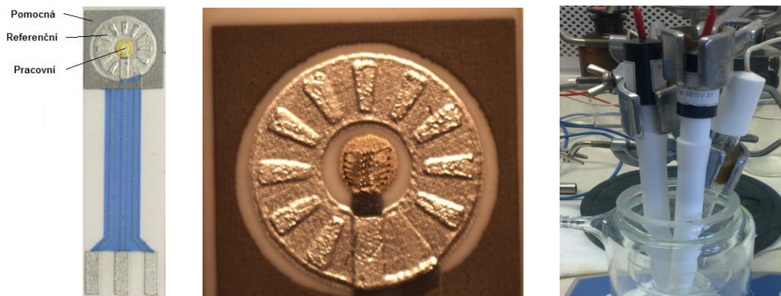
Obrázek 1: Typy použitých senzorů : a) tlustovrstvý senzor typu S-2, b) nasvařované Au drátky na pracovní elektrodě, c) reference
