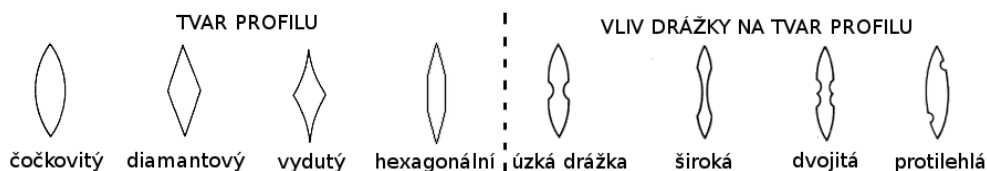
Obrázek 3: Tvary profilů (příčných řezů) čepele a vliv drážky na tvar profilu
