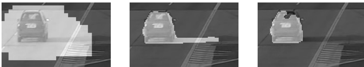
Obrázek 2: Postupná detekce pohybu a odstranění stínů
