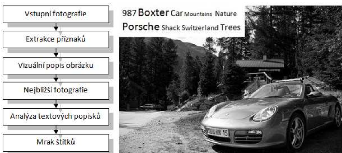
Obrázek 1: Blokové schéma automatického návrhu popisků a výstup programu
