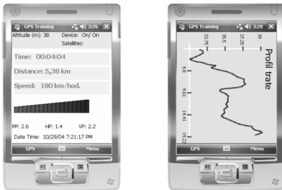
Obrázek 1: Na levém obrázku je zobrazena obrazovka ukazující program ve stavu sběru dat při právě probíhající jízdě. Na pravém obrázku je ukázka jednoho z grafů vykresleného z GPS dat zaznamenaných v GPX souboru.
