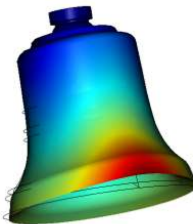
Obrázek 6: Deformace zvonu při úderu
