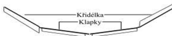
Obrázek 1: Nákres křídla pro lepší představu; každá pohyblivá plocha je řízena samostatným servem.
