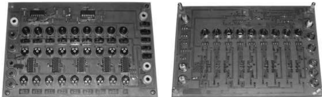
Obrázek 2: Laboratorní vzorek univerzálního analogového oscilátoru
