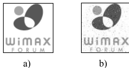
Obrázek 4: Přenos obrázku kanálem AWGN při SNR = 14dB. Obrázek původní a přenesený s FEC (a), bez FEC (b)
