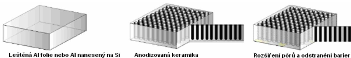
Obr. 2: Schéma vytváření porézní masky pro elektrodepozici.[5]
