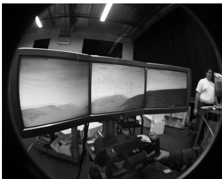
Obrázek 2: Virtuální kokpit se třemi obrazovkami
